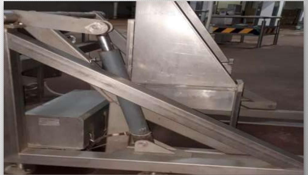
Подъемник -опрокидыватель гидравлический для биг боксов , с высот.опрокид.1600 мм100%испол.нерж.сталь
